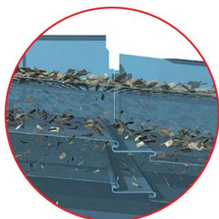
Sur certains modèles il est possible de rajouter un niveau de criblage pour arriver à quatre fractions.
