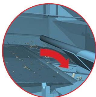
• L'alimentation se fait par une goulotte de chargement, qui distribue le flux de matériau sur toute la largeur du tamis et freine le mouvement du matériau.
